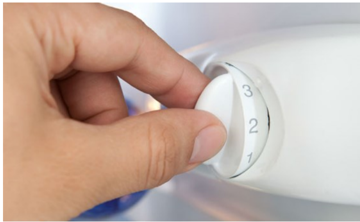
Ajustando o termostato de uma geladeira.
